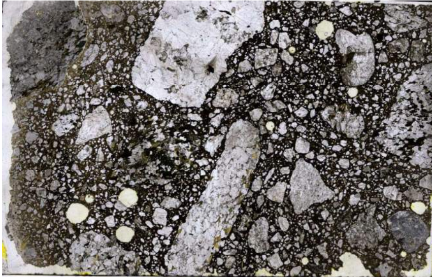
Figur 1 Bilden visar tunnslipsprov kärna 1 32:2 i planpolariserat ljus (övre bild: ballasten syns i vit-grå, luftporerna i gul och cementpastan i brunaktig färg), i korspolariserat ljus (mitten) och i fluorescensljus (nedre bild: sprickor och luftporer syns i ljusare grön färg). Betongytan är till vänster i bilden.
