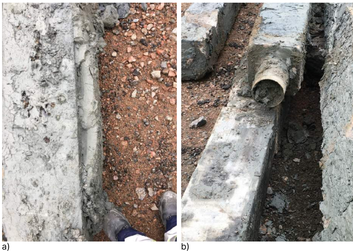
Figur 4.3. Betongpålar efter uppdragning: a) brottyta i lera; b) "rengjord" påle samt skarv mellan betong- och träpålelement.
